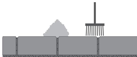
Fugen vollständig füllen
