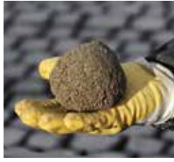
Die optimale Konsistenz ist dann erreicht, wenn der Drain-Bettungsmörtel sich zu einer Kugel formen lässt
